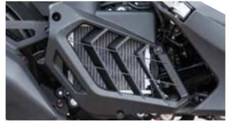
Το φυγείο του κινητήρα των 15 ίππων με το σύστημα Start-Stop βρίσκεται στο πλάι.
